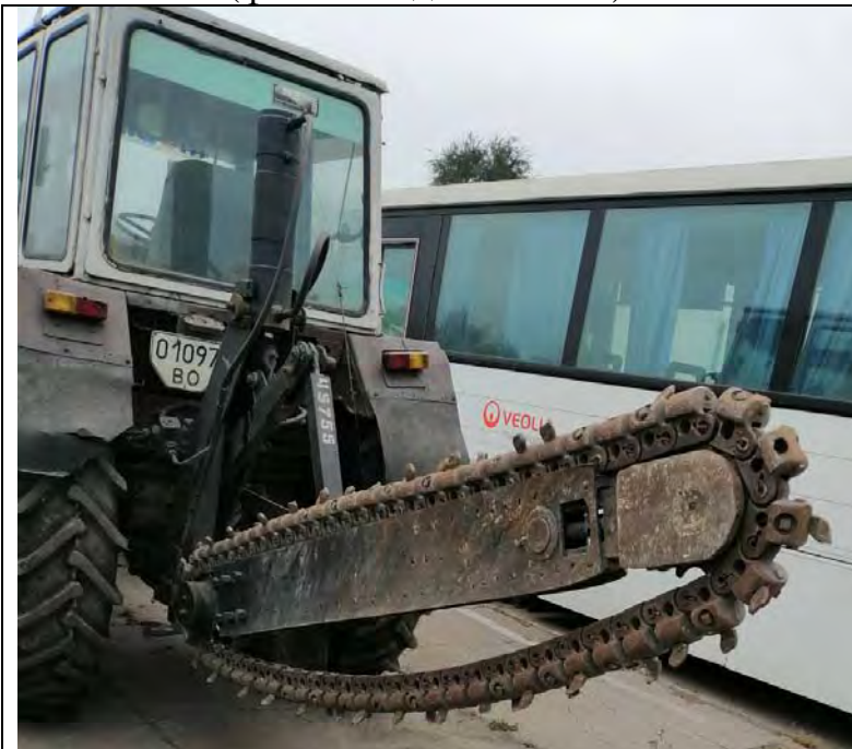
Фото. Існуюча барова установка
