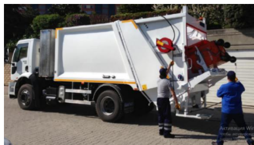
Фото. Сміттєвоз HİDRO MAK з функцією миття та дезінфекції контейнерів
