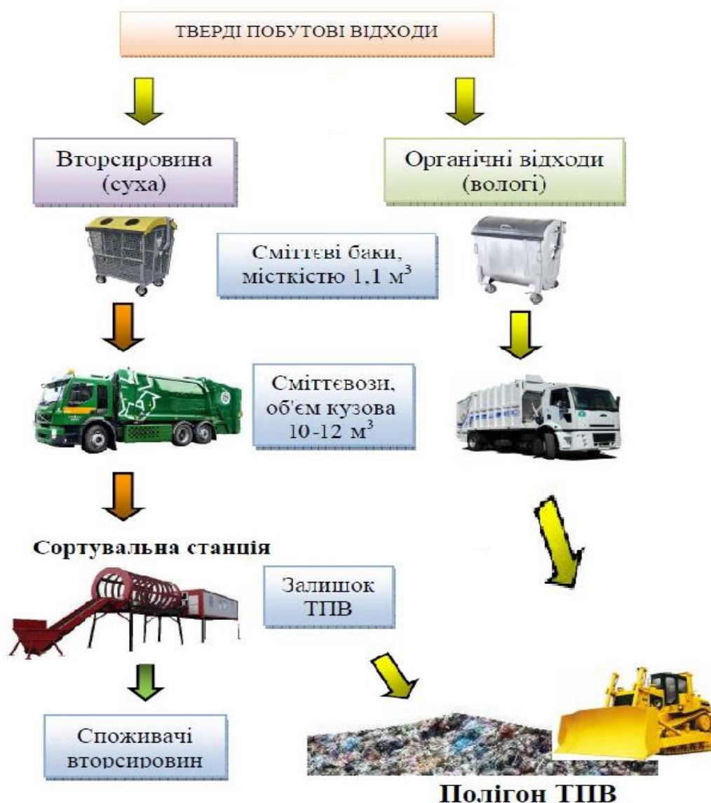
Рис. 2.1 Схема сортування ТПВ на 2 потоки
