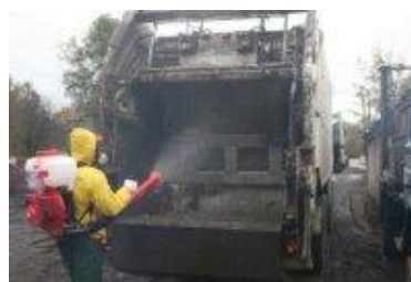
Фото. Дезінфекція контейнерів та сміттєвозів за допомогою аерозольних розпилювачів
