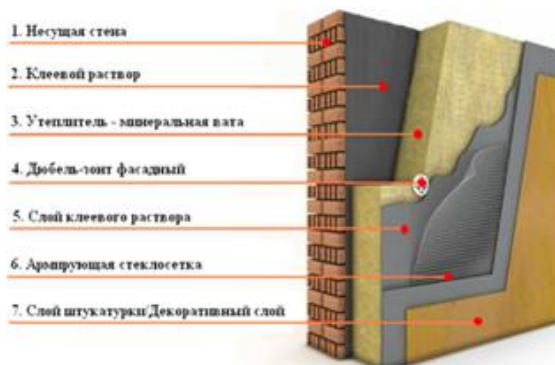
Рис. 2.1. Структура утеплення зовнішньої стіни
